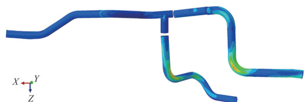
图12 ABAQUS整体分析Mises应力分布图
